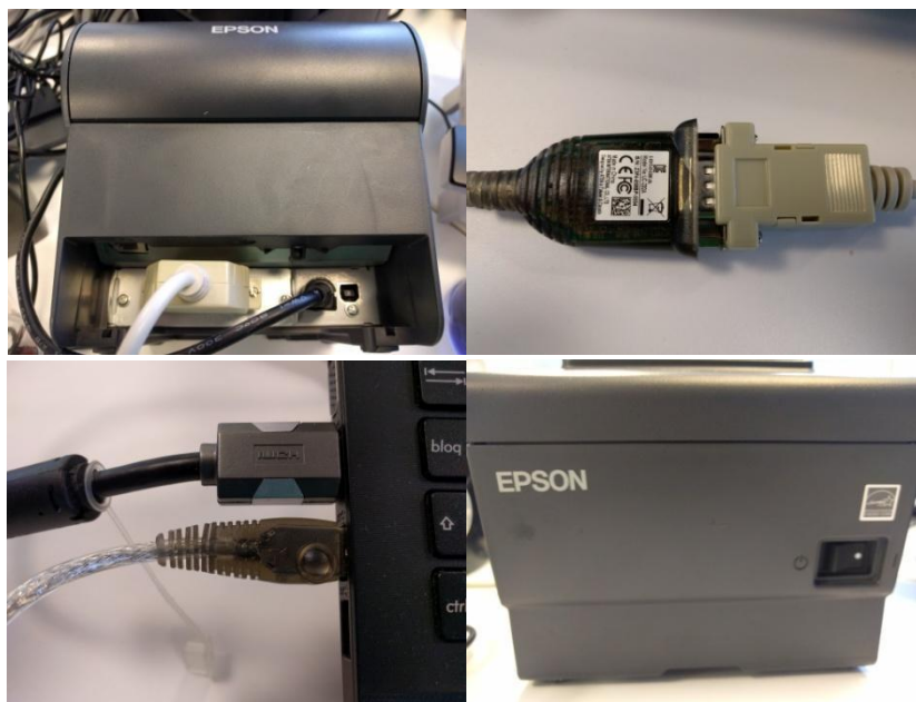
Figura 1. De izquierda a derecha y de arriba abajo: 1) Conexión de cable RS232 y adaptador de corriente. 2) Conexión de cable RS232 a adaptador RS232-USB. 3) Conexión del cable USB al PC. 4) Encendido de impresora.
