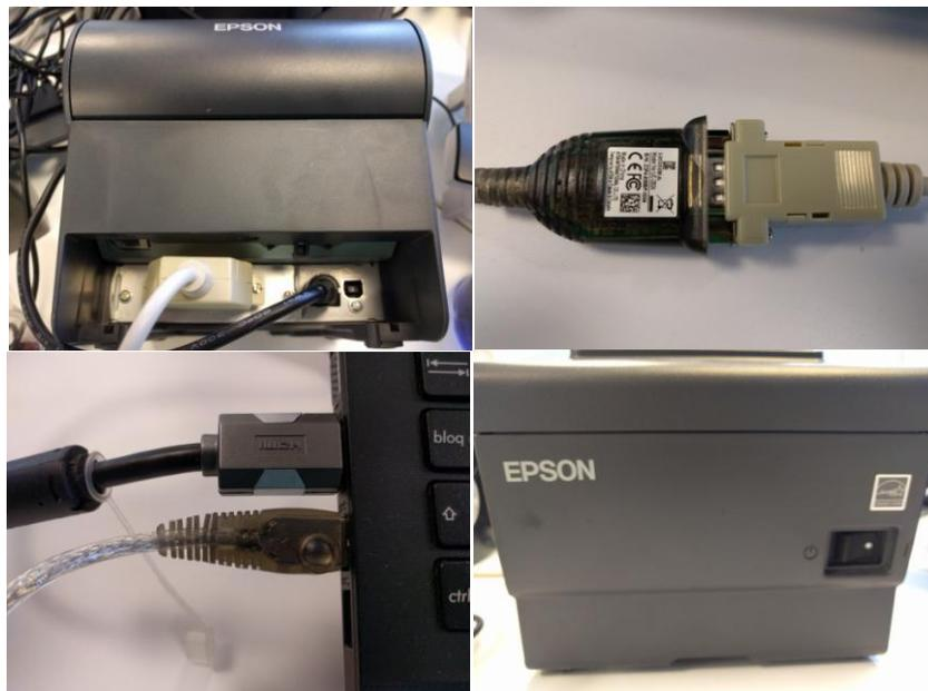
Figura 1. De izquierda a derecha y de arriba abajo: 1) Conexión de cable RS232 y adaptador de corriente. 2) Conexión de cable RS232 a adaptador RS232-USB. 3) Conexión del cable USB al PC. 4) Encendido de impresora.
